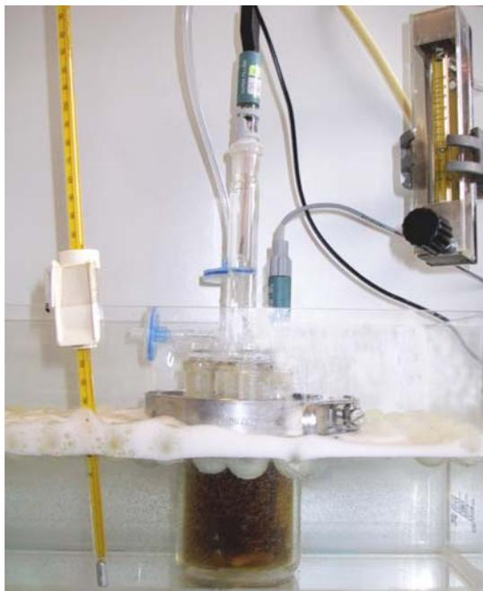
**Abb. 5-5 Amperometrisches Messsystem im Minireaktor**
