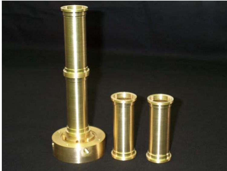
Bild 5.16 : Teilweise montiertes Messingrohr
