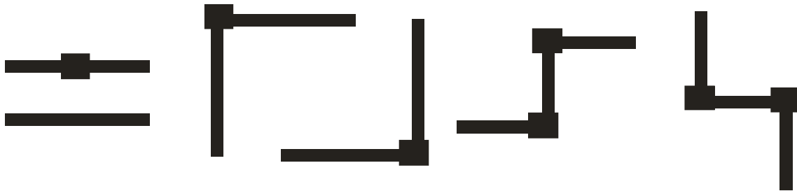
Abbildung 5.3: Via-Positionen der Verdrahtungselemente
