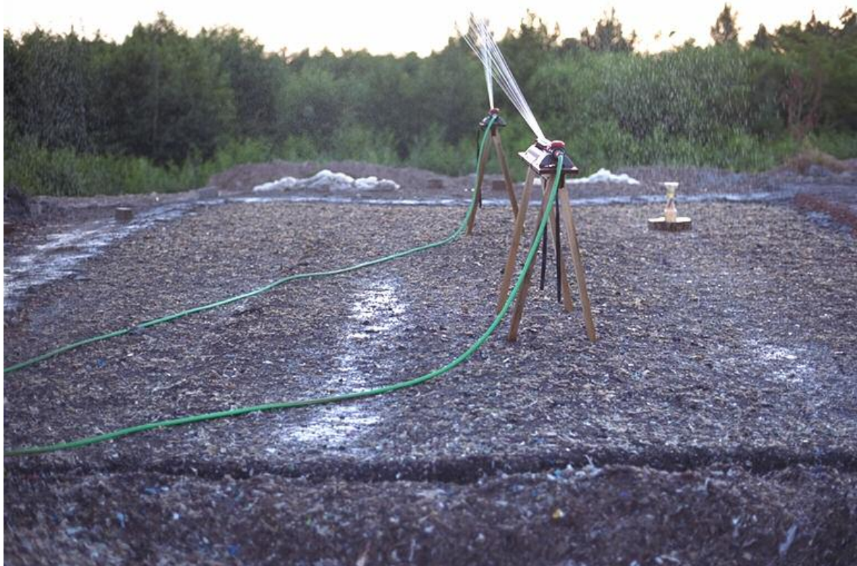
Bild 6-10: Regner und zusätzlicher Regenmesser
