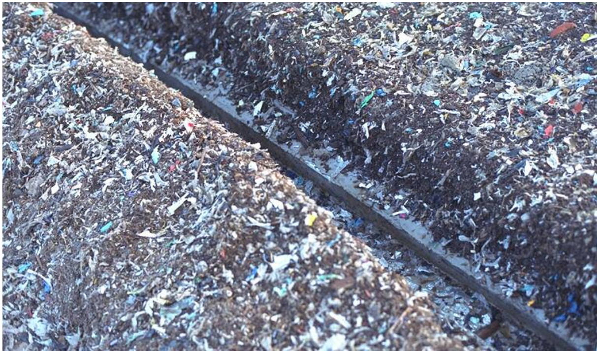
Bild 6-9: Auffangrinne für den Oberflächenabfluss
