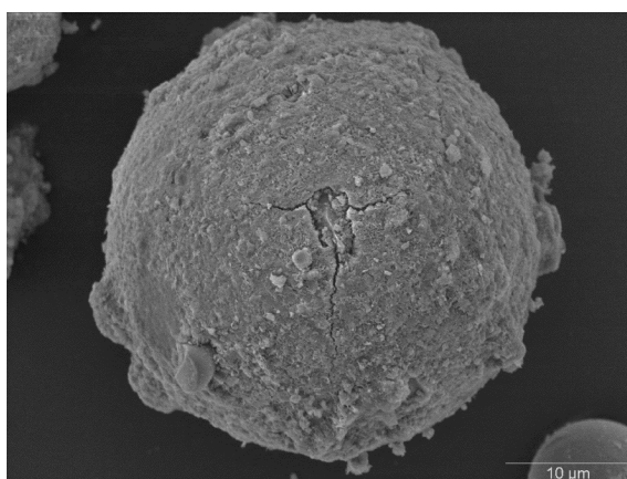
Abbildung 84 (links): REM-Aufnahme einer SG3000-PMMA 8 -Glaskugel, Vergrößerung: 2500 x
