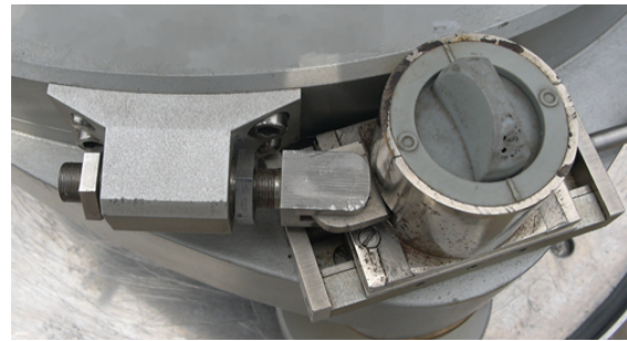
Abb. 3.3: Anschlagsvorrichtung und justierbarer Gelenkbolzen
