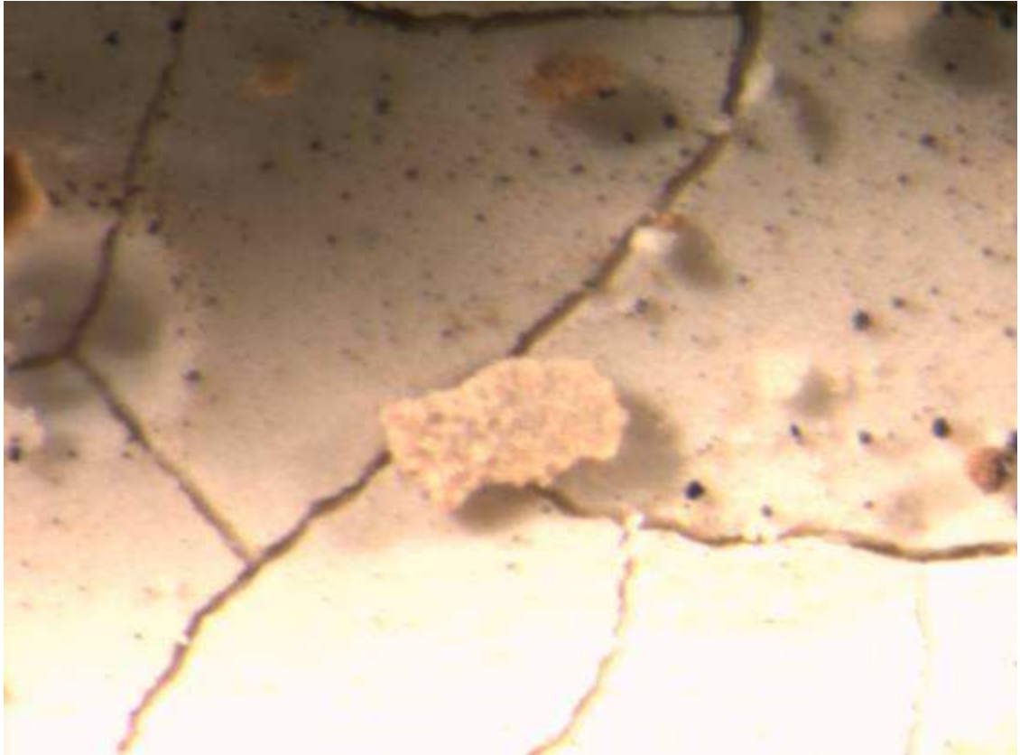
Abbildung 3.58: Beschichtung eines Kanals am Abgaseintritt, Abgasstrom von links nach rechts, Vergrößerung ca. 100fach
