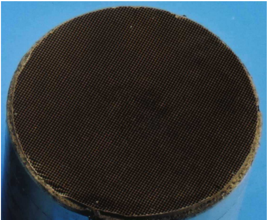
Abbildung 3.51: Abgaszugewandte Seite des Monolithen nach Motorprüfstandsversuch
