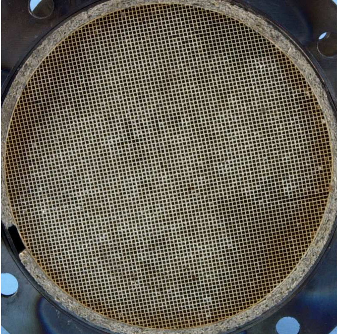
Abbildung 3.52: Abgasabgewandte Seite des Monolithen nach Motorprüfstandsversuch
