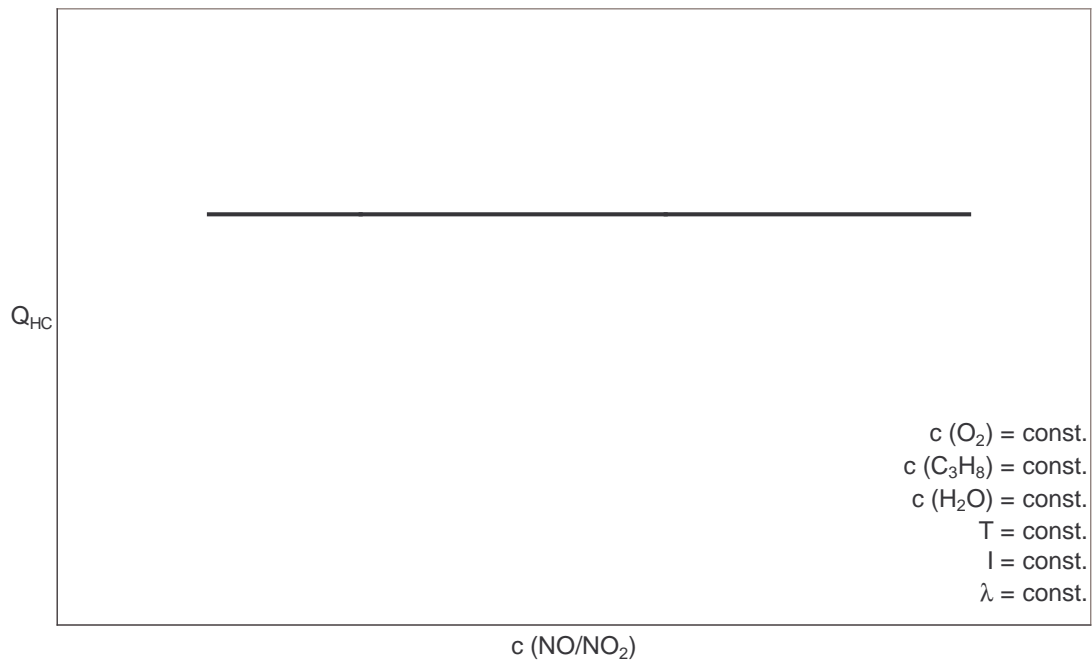
Abbildung 2.11: Schematische Darstellung der Abhängigkeit der Quantenausbeute der HC-Oxidation vom NO/NO 2 -Verhältnis [41]
