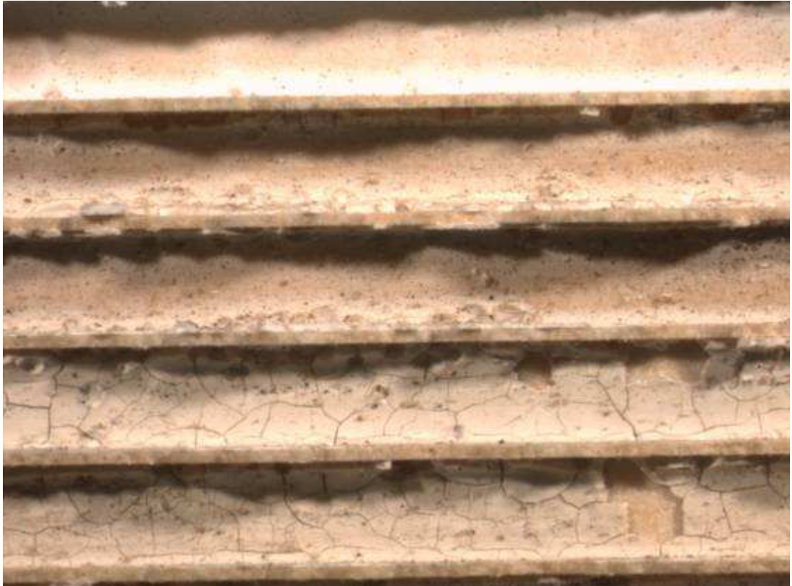
Abbildung 3.57: Längsschnitt durch den Monolith am Abgasaustritt, Abgasstrom von links nach rechts, Vergrößerung ca. 16fach
