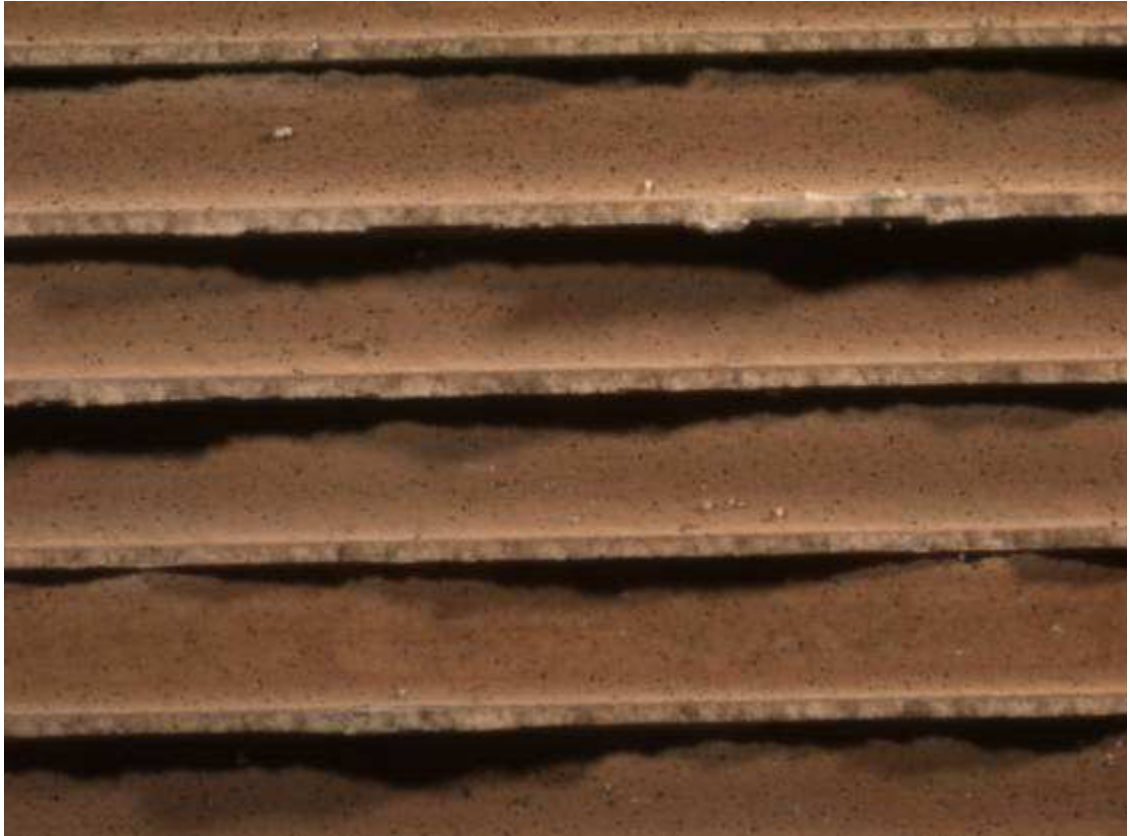
Abbildung 3.54: Längsschnitt durch den Monolith am Abgaseintritt, Abgasstrom von links nach rechts, Vergrößerung ca. 16fach
