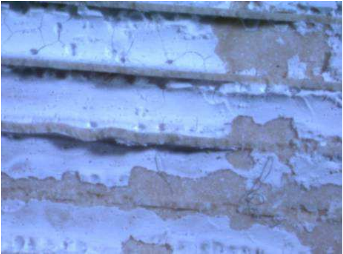
Abbildung 3.28: Längsschnitt durch einen mit Hombifine N beschichteten Monolith, Vergrößerung ca. 20fach
