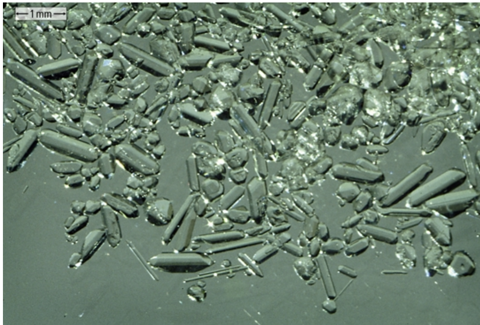
Abbildung 6.4 Produktkristalle der Reaktion von 2,4,6-Trimethylpyridiniumchlorid mit \text{PrCl}_3 \cdot 6\text{H}_2\text{O}
