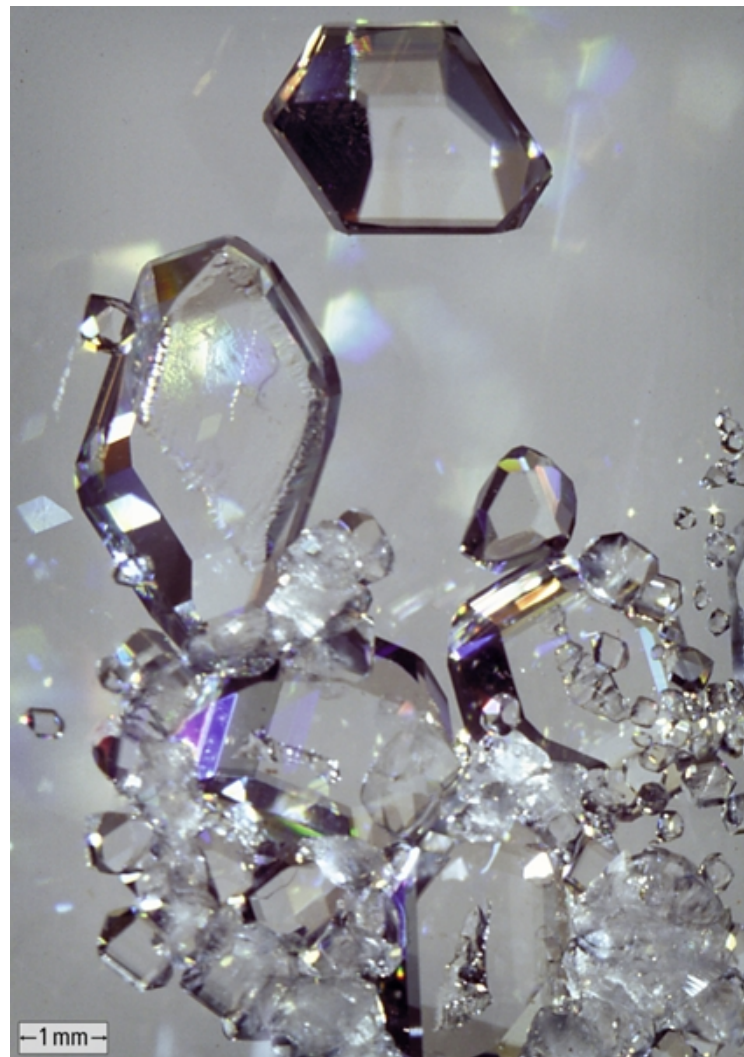
Abbildung 6.1 Produktkristalle der Reaktion von 2,4,6-Trimethylpyridiniumchlorid mit \text{TbCl}_3 \cdot 6 \text{H}_2\text{O}
