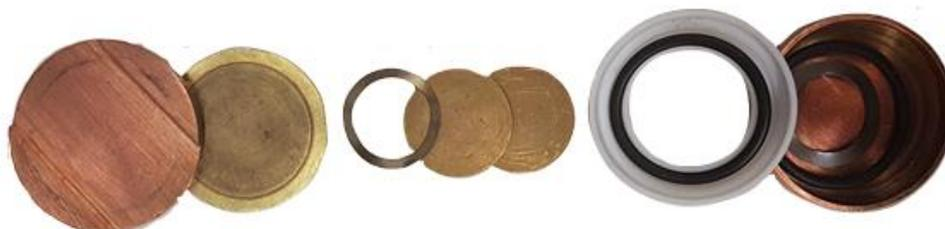
Abbildung 3-4: Beispiel teil-galvanisiertes Bauteil vorher nachher.
