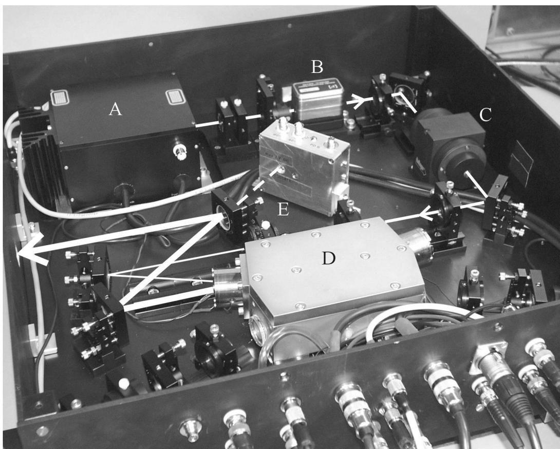
Abbildung 4.11: Foto eines integrierten Systems ohne externe schnelle Phasenkorrektur. A: *Master-Laser*, B: Phasenmodulator für Pound-Drever-Hall-Verfahren, C: Isolator, D: *Slave-Laser*, E: Kombiniertes Photodetektor für Pound-Drever-Hall-Verfahren und Leistungsstabilisierung.
