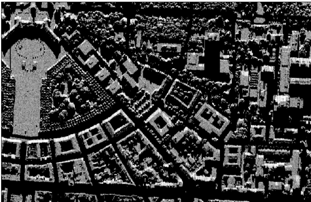
b) Simuliertes SAR-Bild unter Berücksichtigung der Geländeneigung
