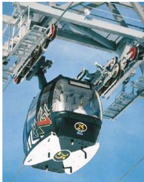
Abbildung 37: Verhindern des Pendelns durch weit auseinander liegende Tragseile [20]
