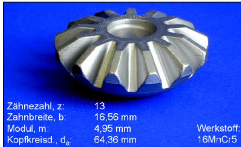
**Bild 2.12:** Präzisionsgeschmiedetes Kegelrad, Werkstoff: 1.7131 (16MnCr5)
