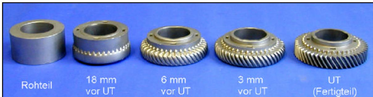
**Bild 7.19:** Darstellung des Werkstoffflusses über der Ausformung des Werkstückes von links nach rechts: Pressenstößel 18 mm, 6 mm, 3 mm vor dem unteren Totpunkt (UT), in UT (Fertigteil)
