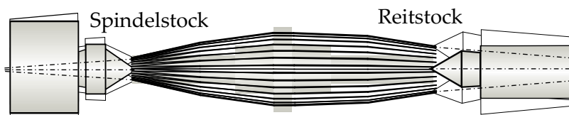
Bild 6.5: Erste Biegeeigenform des Werkstücksystems auf der KARSTENS 16A
