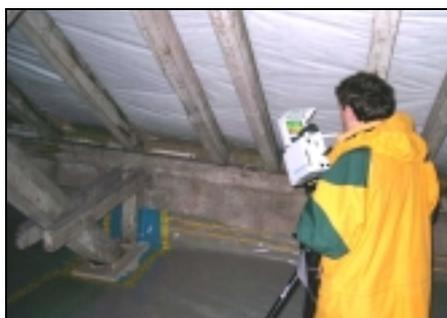
Abb. 5: Thermografie der Dachboden-Luftdichtung
