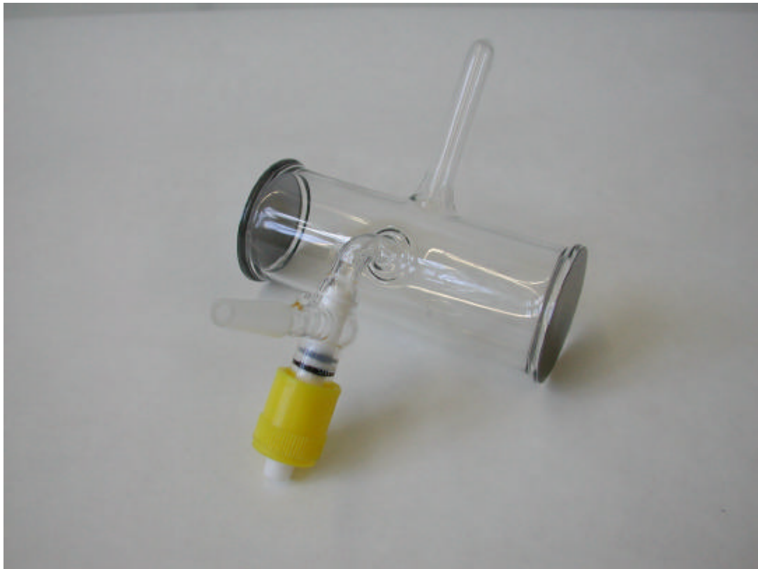
Abb. 3-3: Gasmesszelle mit Siliciumfenstern
