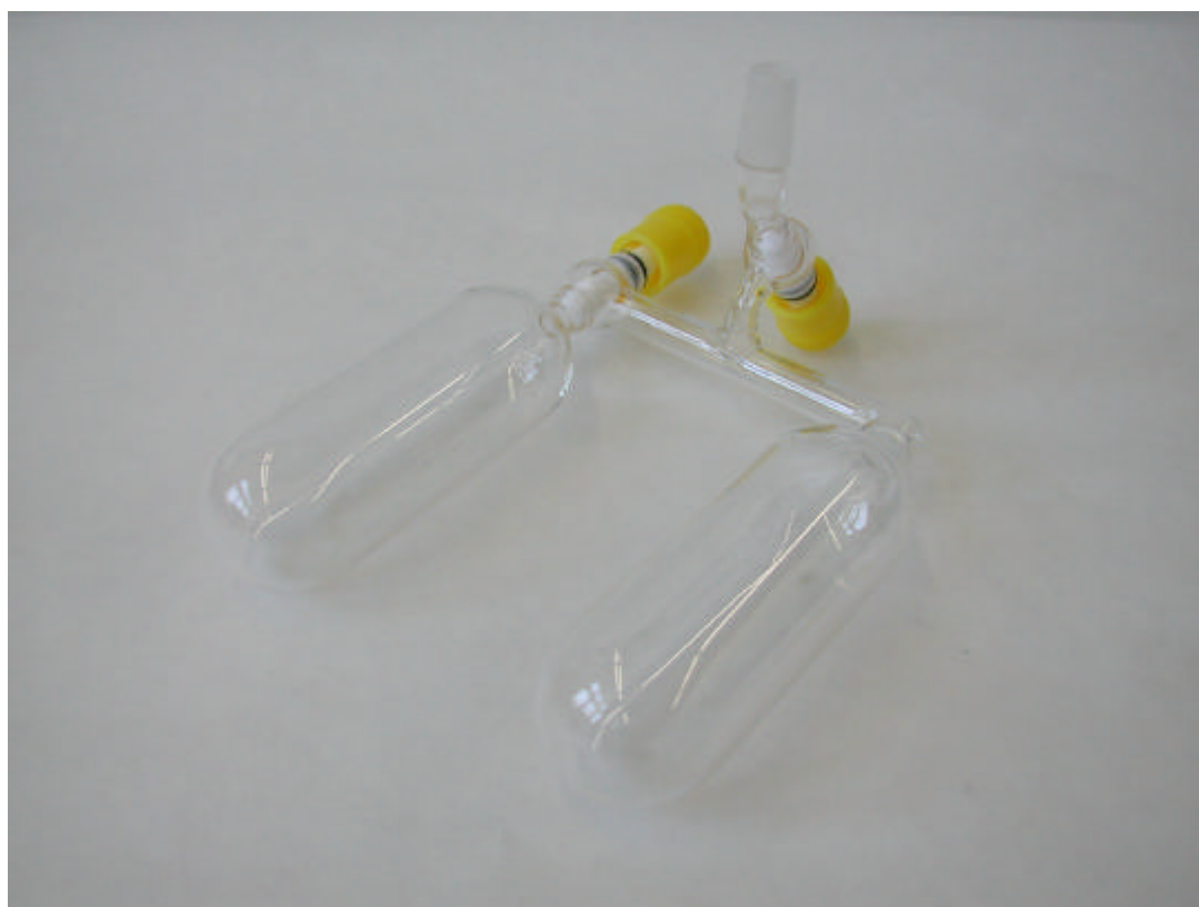
Abb. 2-3: Reaktionsgefäß für instationäre Reaktionsführung
