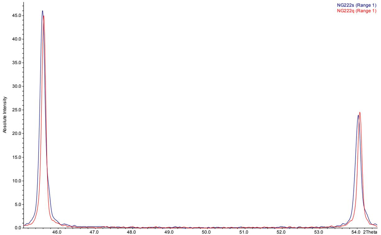
**Abbildung 26:** Pulverdiffraktogramme des QBK (rot) und des SBK (blau), NG222
