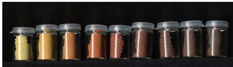
**Abbildung 13:** Mischkristalle im System ZnS / ZnSe, gepulvert
