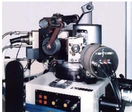
**Abbildung 5:** Pulverdiffraktometer mit Probenwechsler
