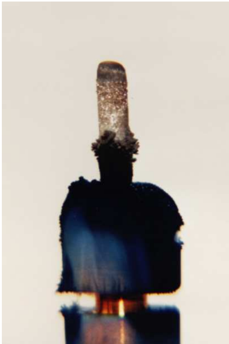
Abbildung C.3: Foto einer Kathode in einer verunreinigten Gasatmosphäre betrieben wurde
