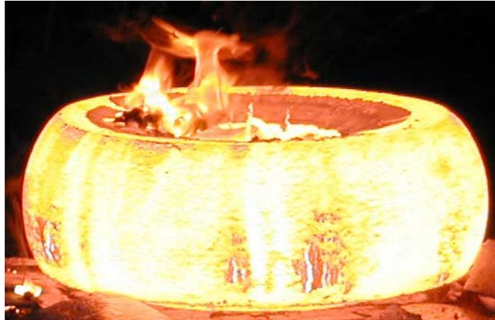
Bild 12: Bombierter Ring nach dem Lochen
