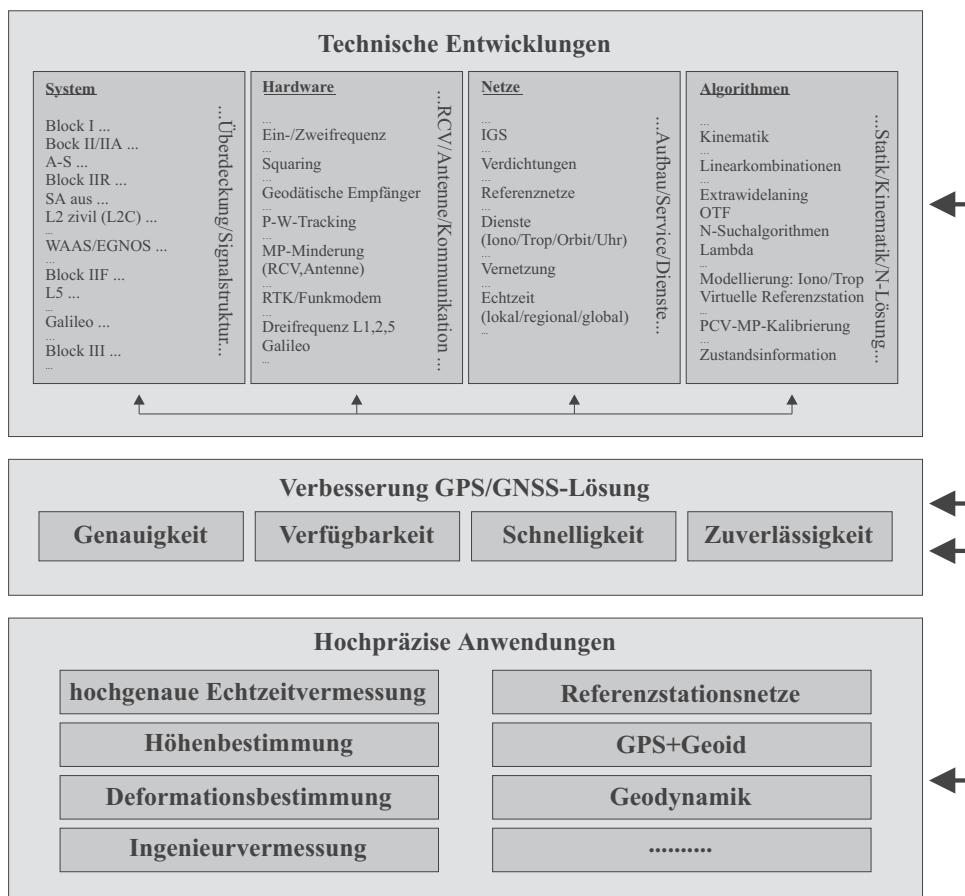
Abbildung 2.3: Beispiele für Entwicklungen des GPS-Systems, präziser GPS-Anwendungen, ihrer Zusammenhänge und Abhängigkeiten.
