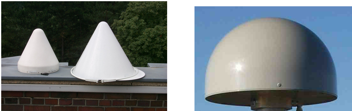
Abbildung 7.14: Beispiele für verschiedene Dome-Konstruktionsformen. Von links: Ashtech (SNOW), Trimble (TCWD), SCIGN-Dome klein (SCIS).
