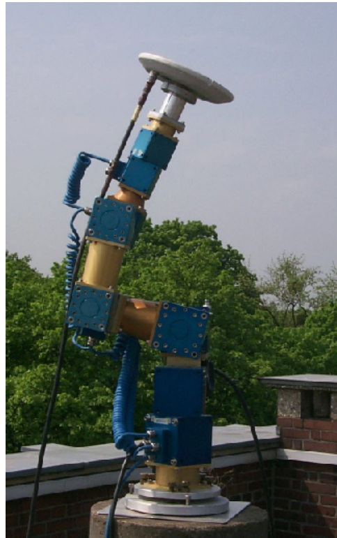
Abbildung 5.16: Roboter mit fünf Freiheitsgraden/Modulen.
