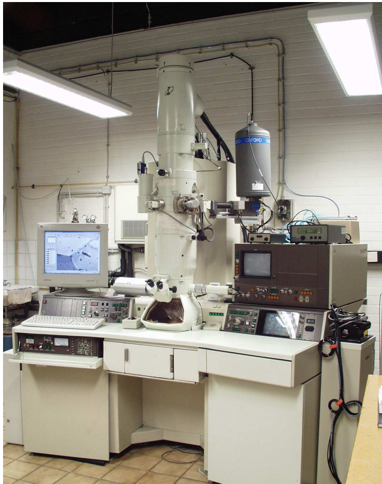
Abbildung 6.3: Transmissionselektronenmikroskop JEM 2010 der Firma JEOL am Institut für Werkstoffkunde.
