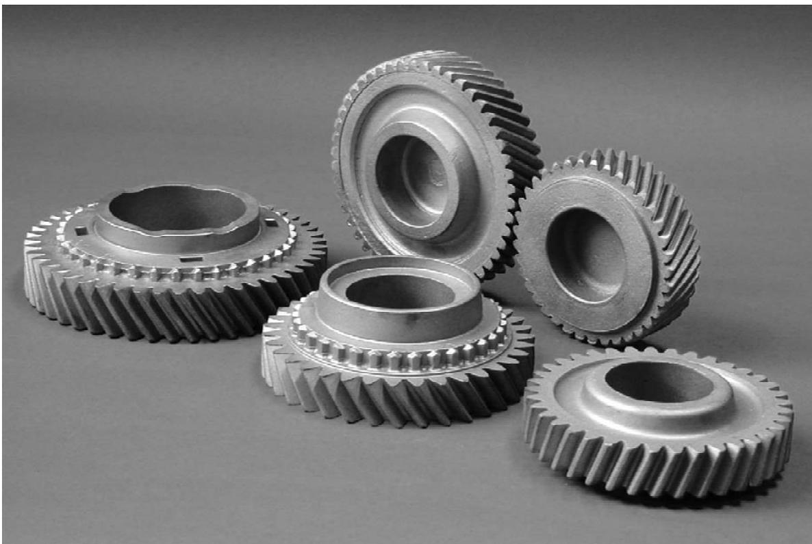
Abbildung 6: Am IFUM präzisionsgeschmiedete Zahnräder [35]
