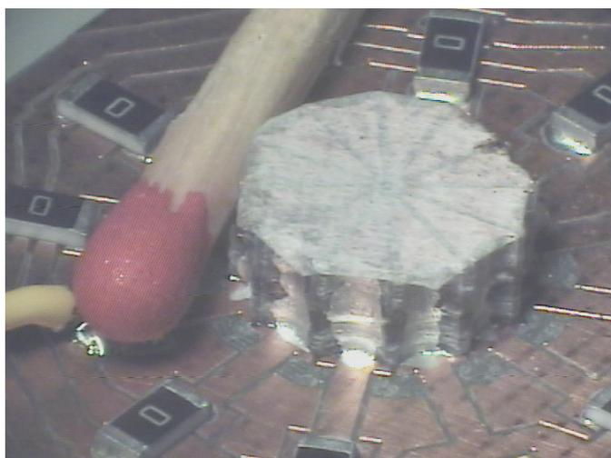
**Abb. 5.5: Untere Elektrodengruppe für Rotations-Levitations Versuche (Rotationselektrode, Herstellungsverfahren: gefräst)**
