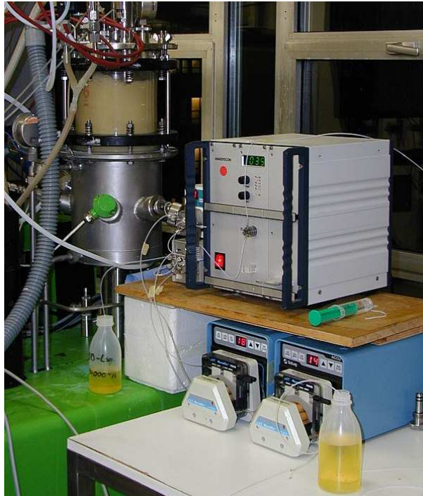
Abbildung 8: Der MBR-Fermenter in Bielefeld mit angeschlossenem FIA-System
