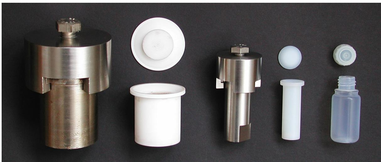
**Abbildung 3.14.** 40- und 10-ml-Autoklaven (rechts und Mitte) mit zugehörigen Einsätzen sowie Teflonfläschchen (rechts).
