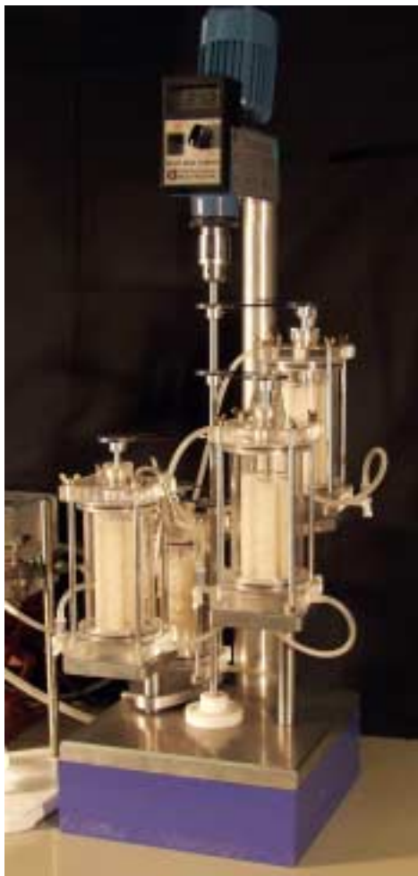
Abb. 5.4.3: Rührkesselkaskade zur Nitratbereicherung in Molke; Links: Photographie des Reaktorsystems; Oben: F(\theta) - Funktion der Rührkesselkaskade, Rührgeschwindigkeit 210 \text{ min}^{-1} , RT [319]
