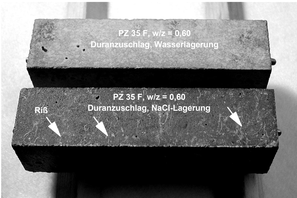
Bild 6.4: Betonprismen aus Portlandzement PZ 35 F mit w/z-Wert 0,60 nach Wasser- und \text{NaCl} -Lagerung.
