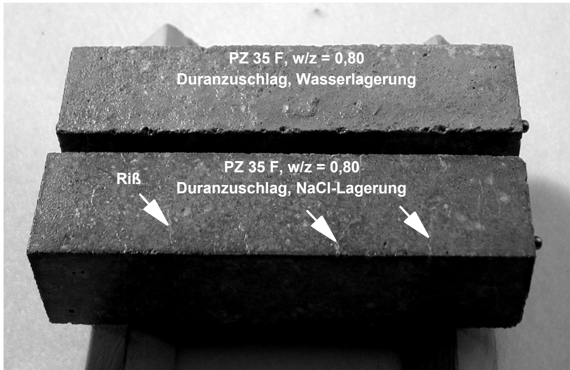
Bild 6.5: Betonprismen aus Portlandzement PZ 35 F mit w/z -Wert 0,80 nach Wasser- und NaCl -Lagerung
