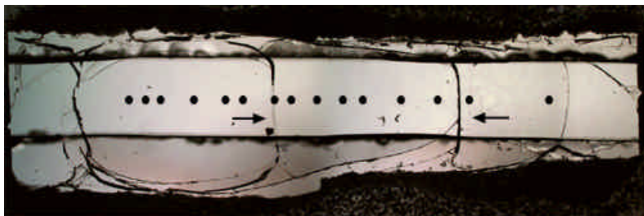
Abbildung 5: Aufnahme einer IR-Diffusionsprobe D20 von ABNa6 nach dem Diffusionsexperiment in der IHPV bei 1613 K mit gemessenem Konzentrations-Diffusionsprofil. Der gemessene Bereich der Probe ist in der Mitte des Schlitzes im Probenhalter (Höhe = 200\mu\text{m} ). Die Pfeile deuten die Risskorrektur an.
