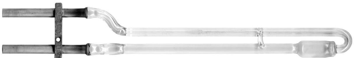
Abb. 3-2 Durchflussreaktor mit einem Außendurchmesser von 12 mm für Reaktionen an gasdurchspülten Pulverschüttungen.
