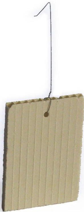
Abb. 4-1 Unbeschichteter Träger mit den Abmessungen  $1.4 \times 2$  cm.
