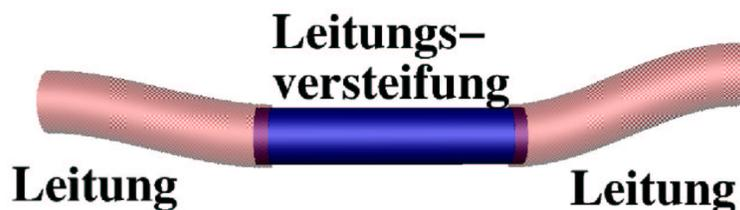
Abbildung 4.12: Beispiel einer Leitungsversteifung
