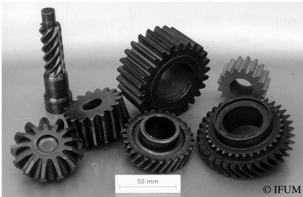
**Abbildung 6:** Auswahl an durch Präzisionsschmieden hergestellter Bauteile
