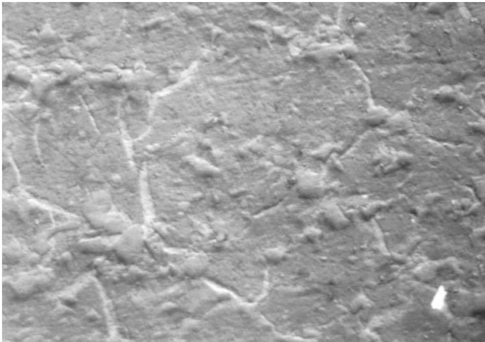
Abb. 2.29: AF 125, Harzeinbettung, Schräglicht (VIS), 1000fache Vergrößerung
