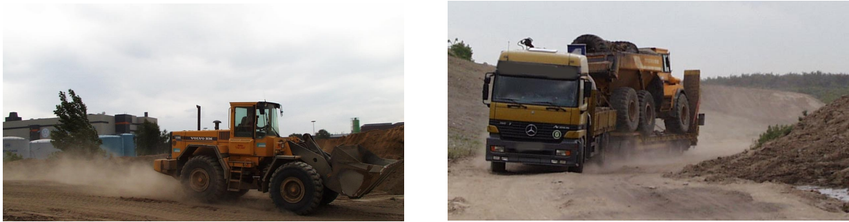
Abbildung 2.4: Dispergierung von Staub durch Baufahrzeuge und schwere LKWs.
