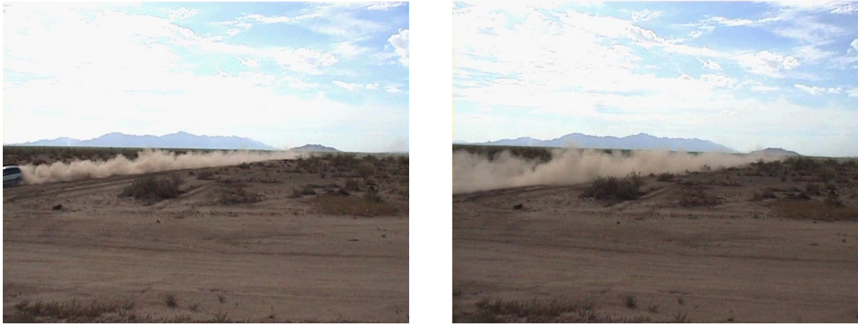
Abbildung 2.3: Entwicklung einer Staubfahne ohne Verlagerung durch den mittleren Wind.
