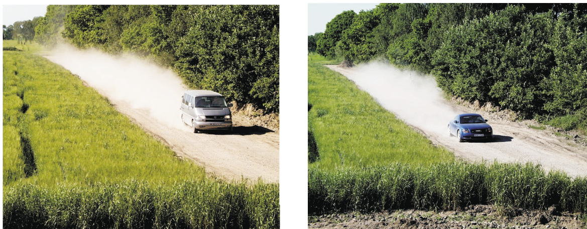
Abbildung 4.13: Vergleich von Staubfahnen hinter einem Vollheckfahrzeug ( links ) und einem Fließheckfahrzeug ( rechts ).
