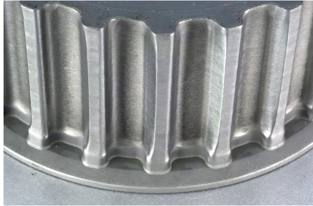
Abbildung 7.27: Verschleiß eines Zahnrades auf dem Komponentenprüfstand.
