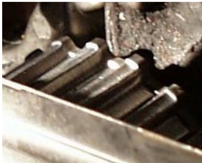
Abbildung 7.28: Verschleiß eines Zahnrades in einem Gabelstapler.
