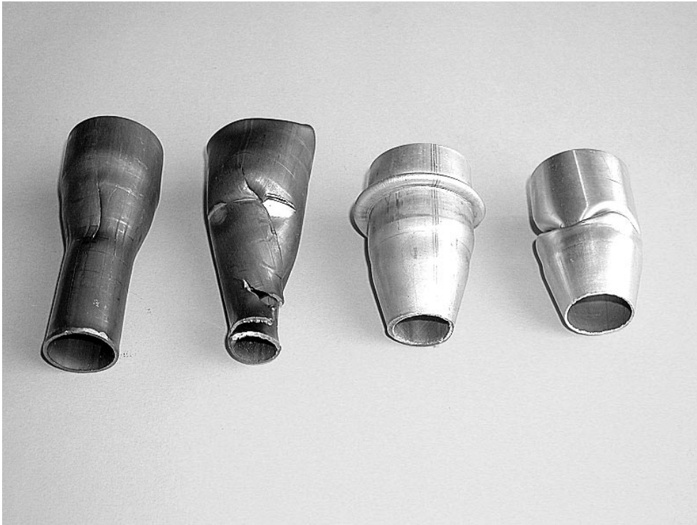
Bild 4.23: Versagensarten von Verjüngungscrashabsorbern: beginnende und fortgeschrittene Rissbildung (links) und Übergang zur Faltung (rechts)
