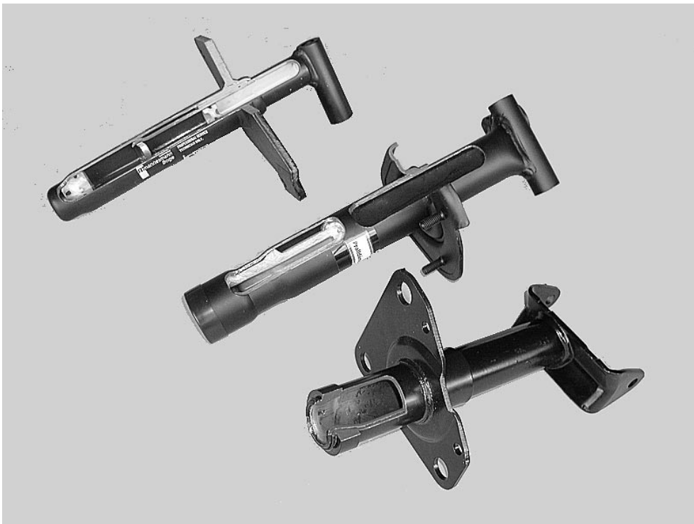
Bild 1.10: Beispiele realer Crashabsorber: Hydropneumatischer Pralldämpfer mit irreversiblen Anteil durch Aufweitung der Firma ZF Boge im VW Jetta (USA) (links), Gummi-Pralldämpfer mit irreversiblen Anteil durch Aufweitung der Firma ZF Boge im 3er BMW Heckmodul (mitte), Crashabsorber nach dem Verjüngungsprinzip der Firma Suspa im VW Passat (rechts)
