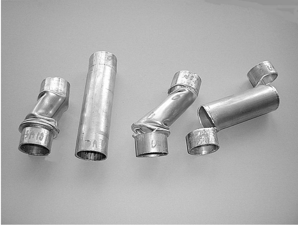
Bild 6.11: Deformierte Faltungsabsorber \varnothing 50 \times 2 \times 125 -AlMgSi0,5 mit biegesteifer Anbindung nach einem Schrägaufprall mit \alpha = 10^\circ (links) bzw. \alpha = 20^\circ (rechts)
