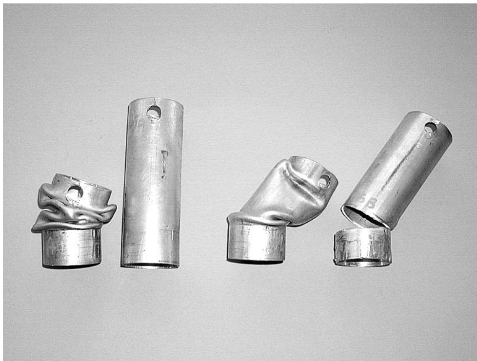
Bild 6.5: Deformierte Faltungsabsorber \phi 50 \times 2 \times 100 -AlMgSi0,5 mit gelenkiger Anbindung nach einem Schrägaufprall mit \alpha = 5^\circ (links) bzw. \alpha = 15^\circ (rechts)
