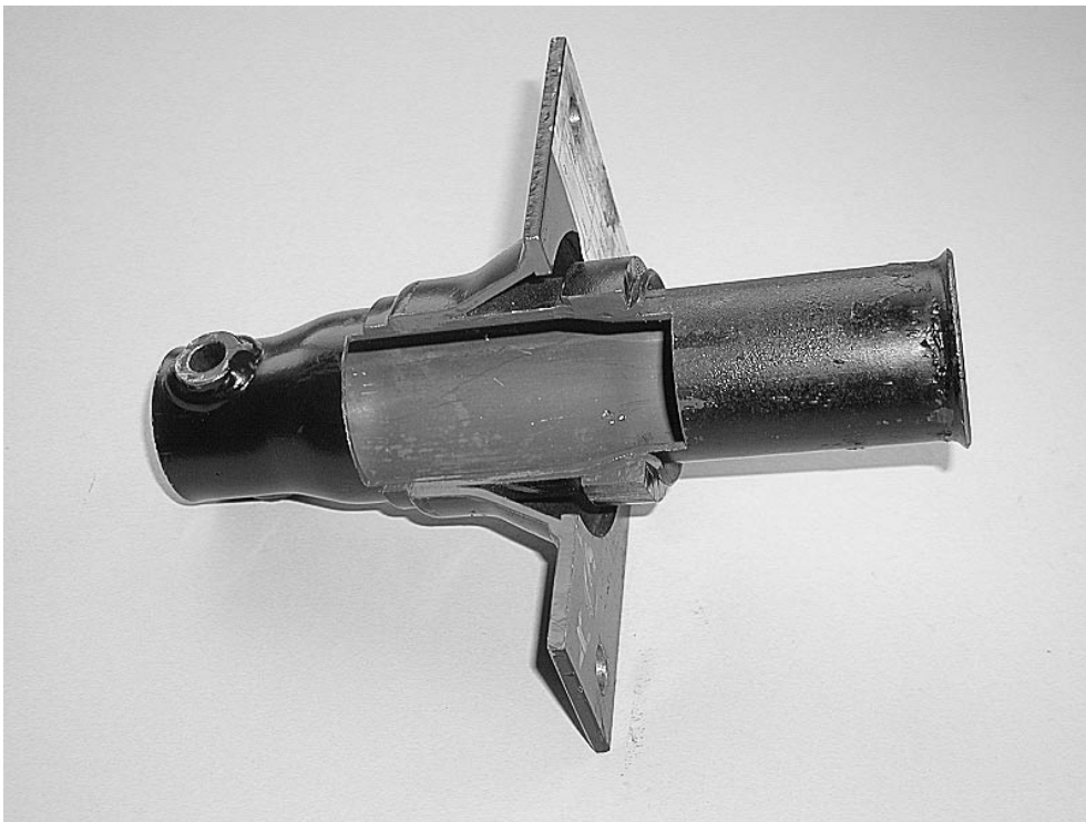
Bild 6.22: Deformierter Prototyp eines Verjüngungsabsorbers der Firma Suspa für das Heck des Ford Mondeo \varnothing 50 \times 2 \times 109 -St, der speziell für den Schrägaufprall optimiert wurde ( \varphi_D = 0,15 ; \alpha_D = 15^\circ )
