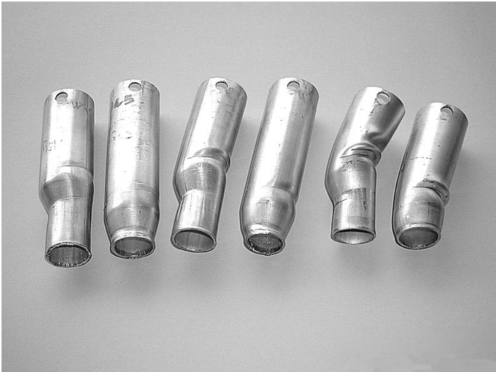
Bild 6.17: Deformierte Verjüngungsabsorber \varnothing 50 \times 2 \times 125 -AlMgSi 0,5 nach einem Schrägaufprall mit \alpha = 5^\circ (links), \alpha = 10^\circ (mitte) und \varnothing 50 \times 2 \times 100 -AlMgSi 0,5 nach einem Schrägaufprall mit \alpha = 20^\circ (rechts) mit gelenkiger Anbindung ( \varphi_D = 0,25 ; \alpha_D = 15^\circ )
