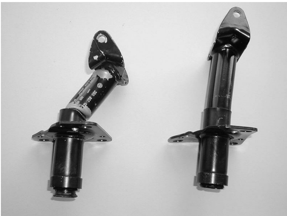
Bild 6.1: Abgeknickte Verjüngungsabsorber des VW Passat bei 20°-Schrägaufprall unter Verwendung des originalen Querträgers
