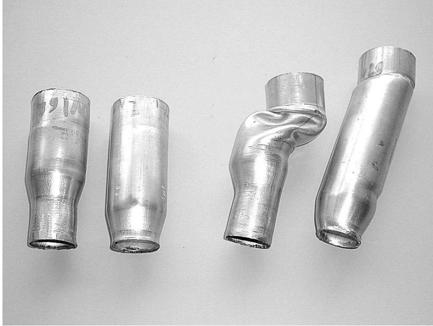
Bild 6.25: Deformierte Verjüngungsabsorber \phi 50 \times 2 \times 55 -AlMgSi0,5 (links) und \phi 50 \times 2 \times 110 -AlMgSi0,5 (rechts) mit biegesteifer Anbindung ( \alpha = 20^\circ ; \varphi_D = 0,25 ; \alpha_D = 15^\circ )
