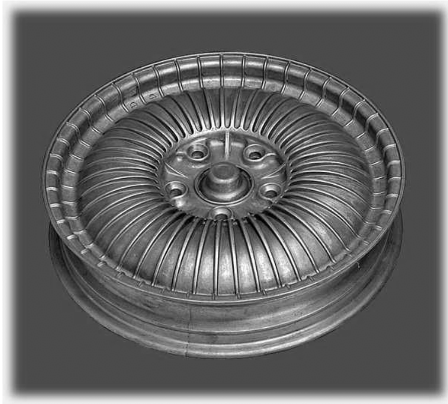
Bild 2.23: Guss-Magnesiumfelge für Notrad, Durchmesser 470 mm, 3 kg, 10 mm mittlere Wandstärke, (Fa. Georg Fischer Mössner)
