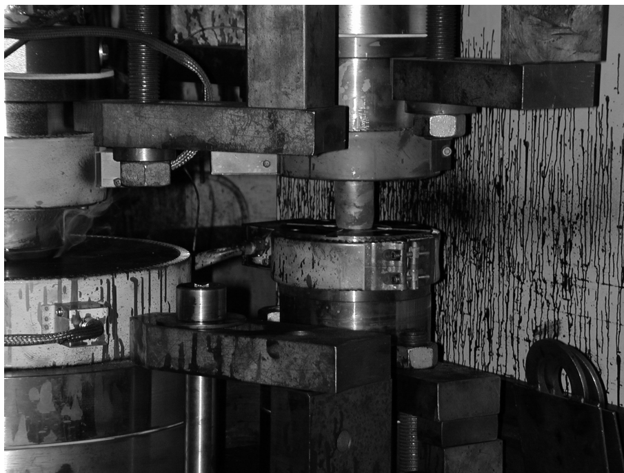
Bild 7.5: Erste Stufe: Anstauchen der Ausgangsform zur Vorform
