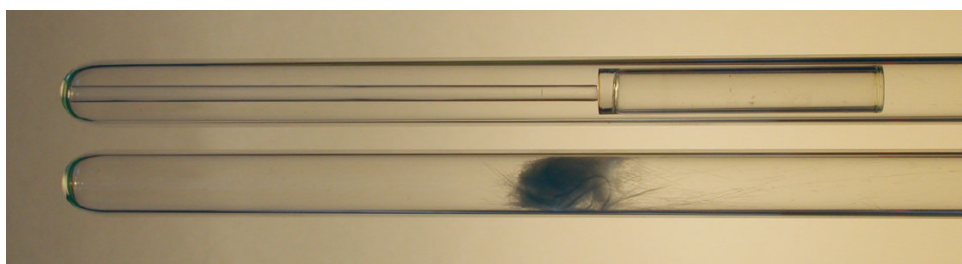
Abbildung 3.4. Ampullen mit Glaswollstopfen und Reagenzglas.
