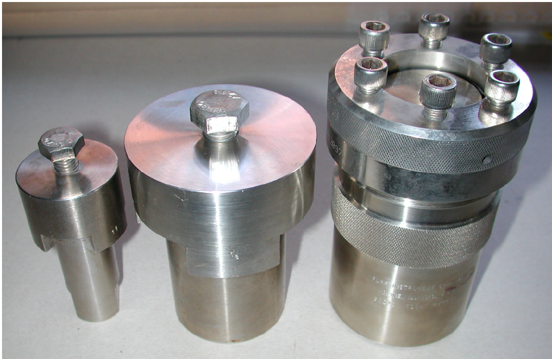
Abbildung 3.16. 10-mL-, 50-mL- und 125-mL-Edelstahlautoklaven (von links nach rechts).
