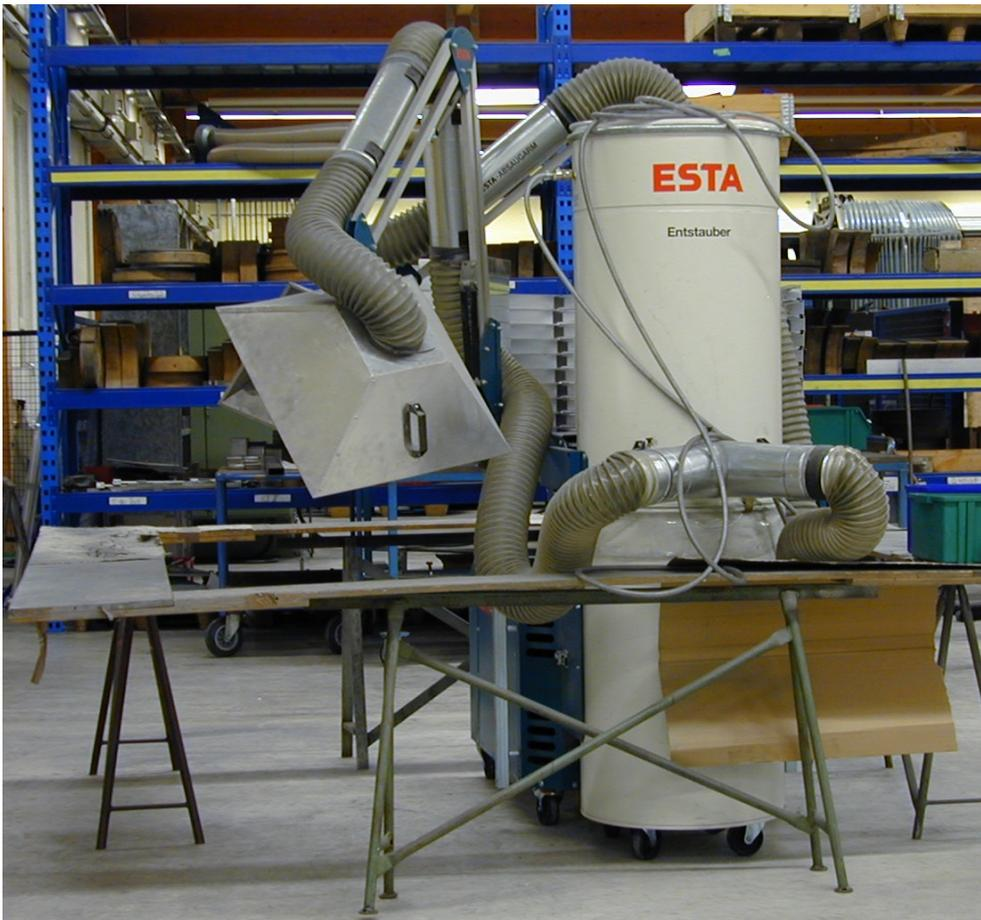
Abbildung 4.1: Absauganlage in der untersuchten Halle. Um die Luftschichtung in der Halle möglichst wenig zu beeinträchtigen, wären gekapselte Räume ideal. Eine Umluftabsauganlage, wie im Bild sichtbar, ist bei kleinen Volumenströmen akzeptabel.
