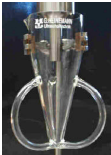
Abb. 7: Dreiarmlige Rosett-Zelle für Ultraschall-Zellaufschluß
