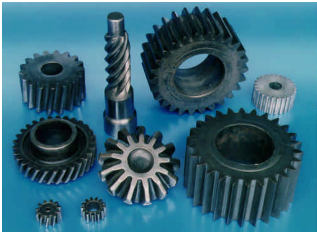
Bild 8 : Am IFUM präzisionsgeschmiedete, verzahnte Bauteile
