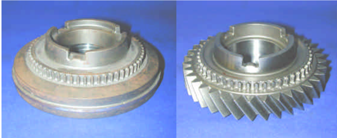
Bild 4: Geschmiedete Vorform und weichbearbeitetes Zahnrad (Volkswagen)
