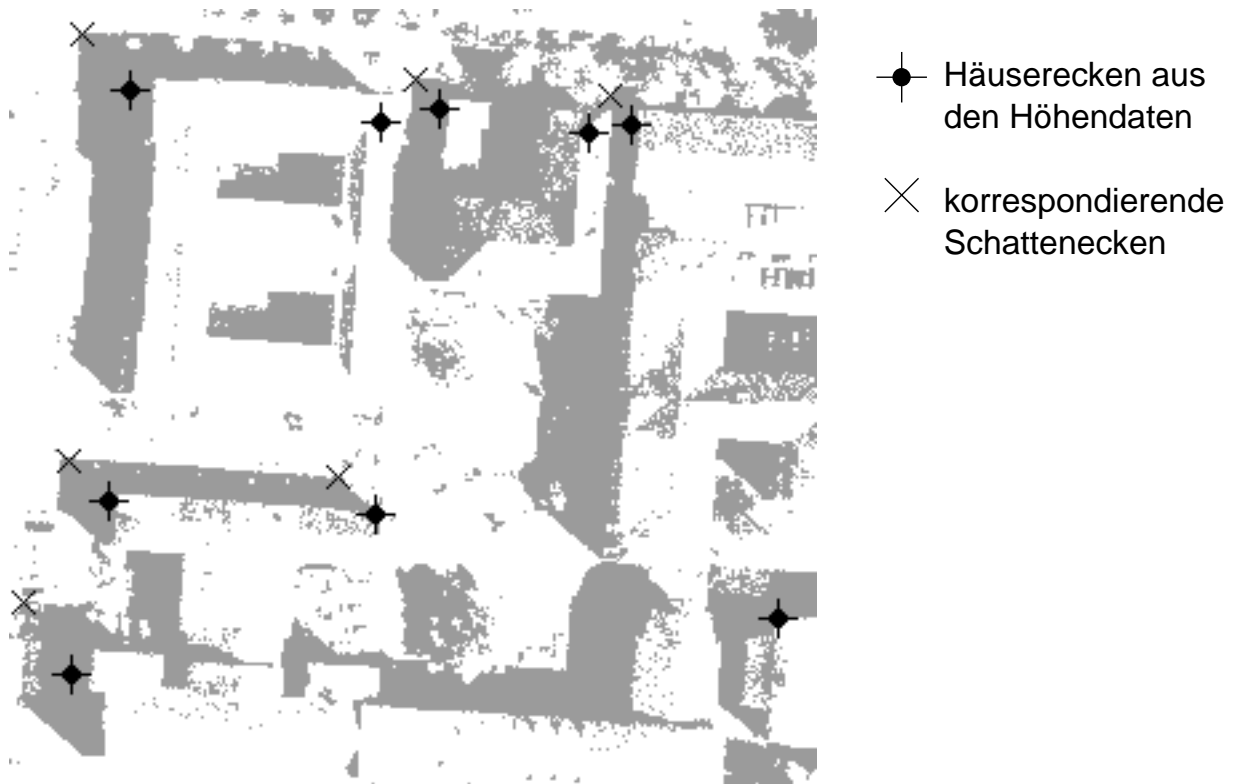
Abbildung 3.20: Schattenbild mit eingezeichneten Gebäude- und Schattenecken
