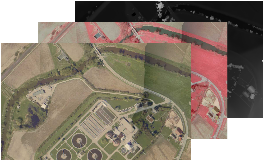
Abbildung 6.8: Szene Ravensburg, multisensorielle Daten (VIS, IR, Laserscan)
