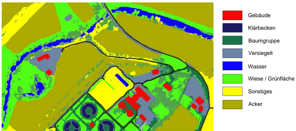
Abbildung 6.9: Ergebnisse der Objekterkennung für die in Abbildung 6.8 dargestellten Daten
