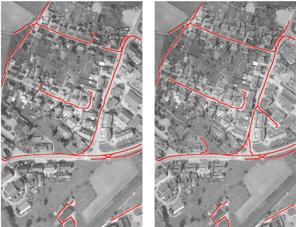
Abbildung 3.27: Ergebnisse der Straßenextraktion auf dem Originalbild (links) und dem radiometrisch entzerrten Bilddaten (rechts)
