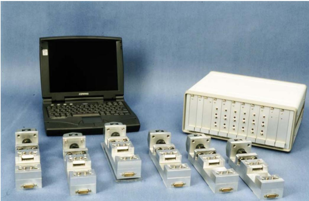
**Abbildung 10:** Elektromechanisches Stimulationsgerät zur Dehnung von Silikonschalen, bestehend aus einer computergestützten Antriebssteuerung, sowie den Einspannvorrichtungen mit Linearmotor.
