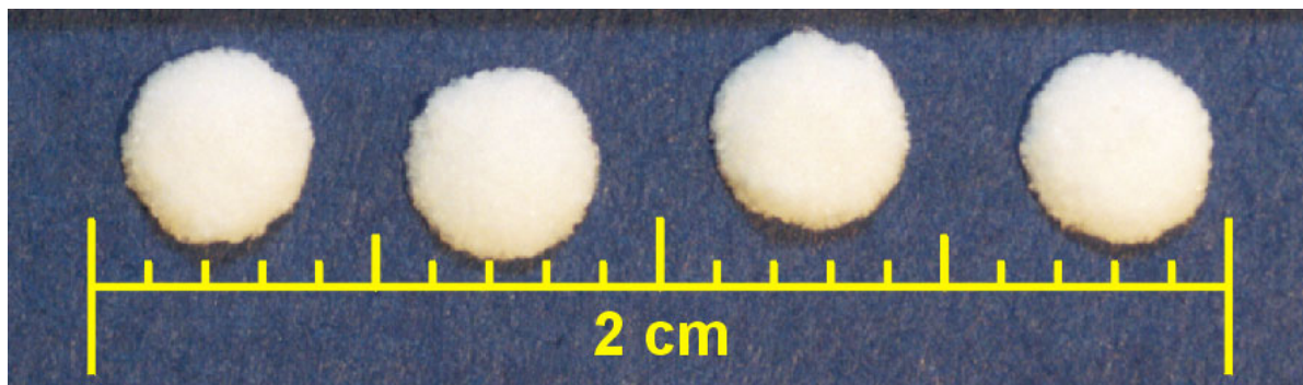
Abbildung 4-23: LentiKats ® mit Calciumsulfid. Größenvergleich.
