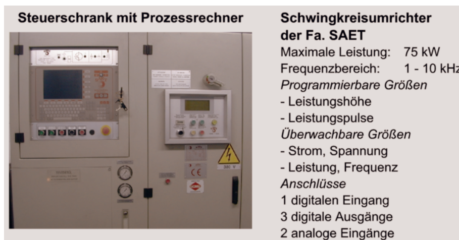
Bild 6.3: Für die Untersuchungen eingesetzte Erwärmungsanlage und technische Daten
