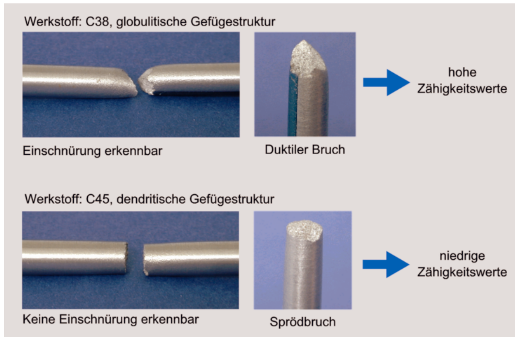
Bild 8.28: Vergleich der Bruchflächen von C38 und C45
