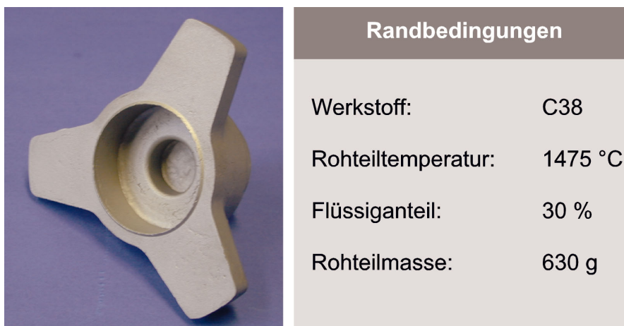
Bild 8.5: Thixogeschmiedeter Verbindungsflansch aus C38
