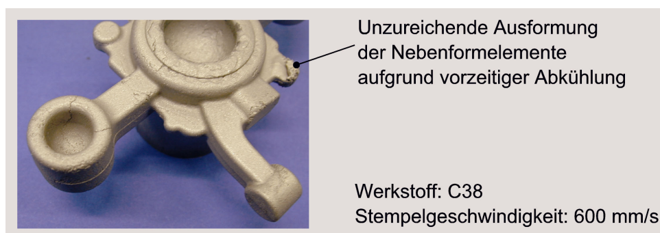
Bild 8.33: Unzureichende Ausformung der Nebenelemente bei einer Stempelgeschwindigkeit von 600 mm/s (Werkstoff: C38)
