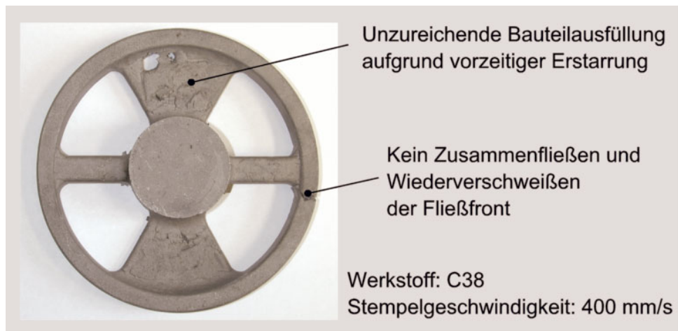
Bild 8.23: Unzureichende Bauteilausfüllung aufgrund zu geringer Stempelgeschwindigkeit
