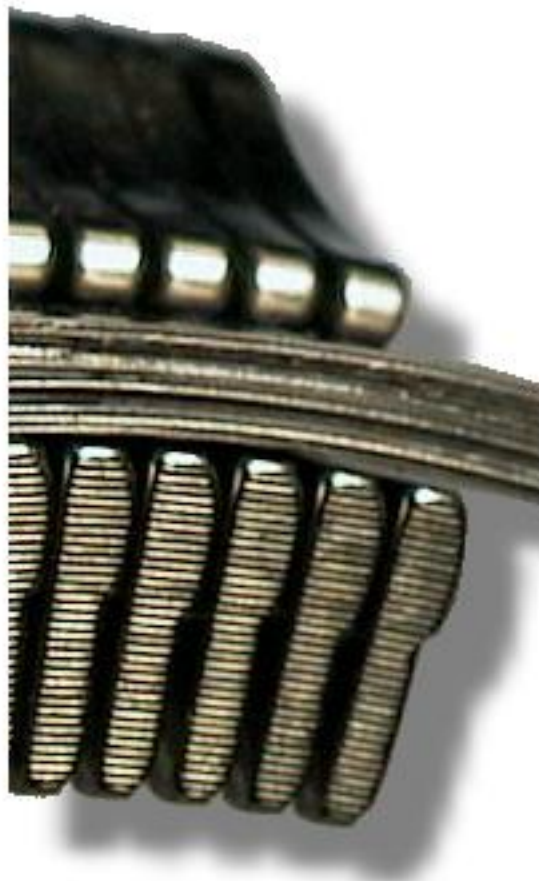
Abb.3.2.1.2.: Drainagerillen auf den Schubgliederflanken
