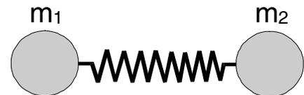
Abb. 10: Zweiatomiges Molekül als klassischer mechanischer Oszillator
