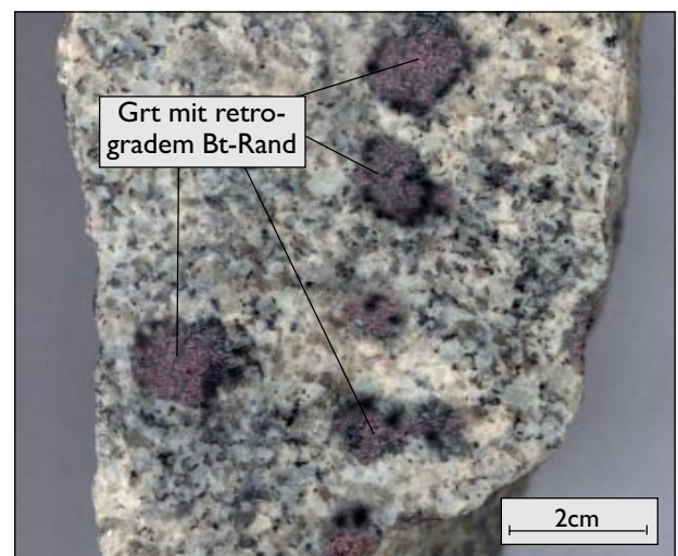
Abb. 48: Homogen verteilte, von Bt umsäumte Grt in einem Grt-Crd-führenden Mikroklin-Granit, Probe W2
