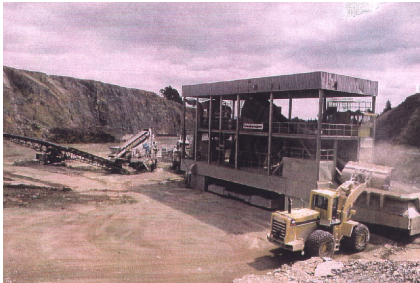
( Beschickung des Schreitbrechers durch einen Radlader )
