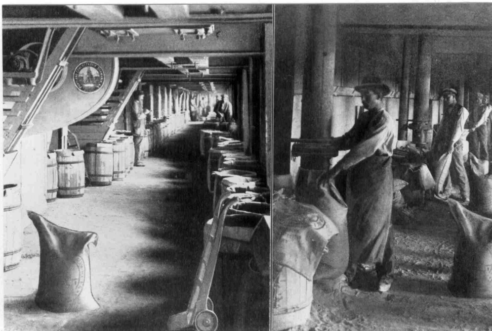
Bild 16: Befüllung von Jutesäcken und Fässern
