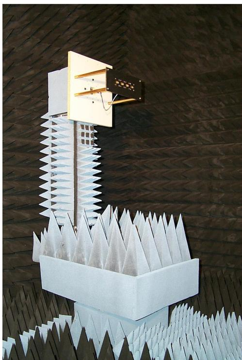
Bild E.1: 4-Elemente-Zeile im Messaufbau
