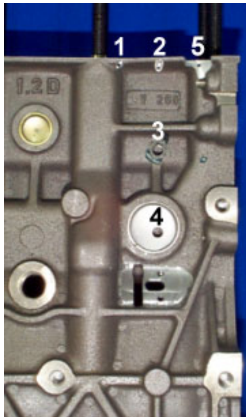
Bild 47: Anordnung der Thermoelemente am ZKG
