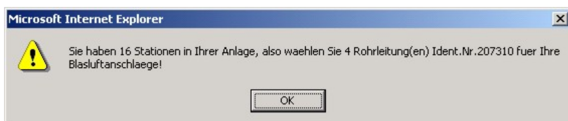
Abbildung 34: Fehlermeldung „Blasluftanschlüsse ohne Rohrleitungen“
